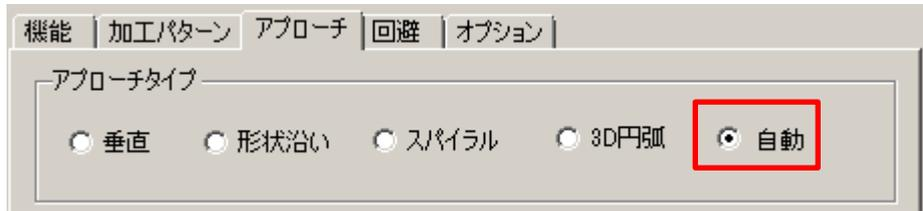
アプローチタイプを「自動」に設定した場合は、以下の優先順位で、形状に合った最適なアプローチが設定されます。
